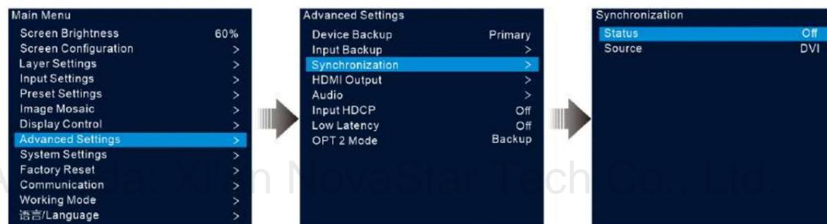
Fase 2 Ruotare la manopola per selezionare **Stato** e premere la manopola per confermare. Ruotare nuovamente la manopola per selezionare **On** e premere la manopola per confermare.
