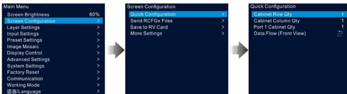
Passaggio 3 Ruotare la manopola per selezionare **Porta 1 Quantità armadio** per impostare la quantità di armadi caricati dalla porta Ethernet 1.
