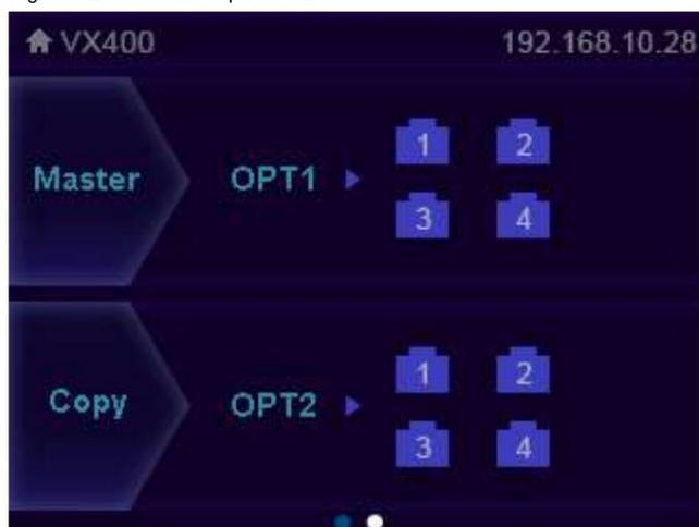
☺ Master > Porta: visualizza gli stati di connessione e backup delle porte Ethernet del VX400.
