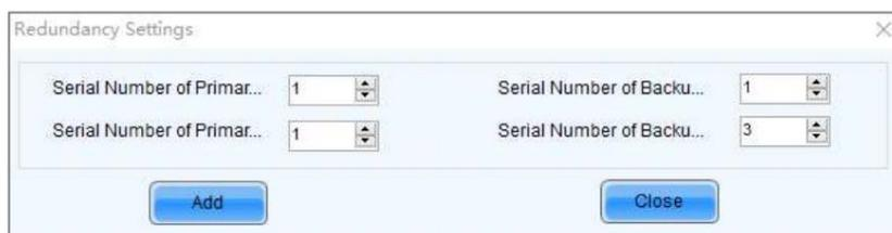
Passaggio 7 Fare clic su **Aggiungi** per completare le impostazioni di backup di una porta Ethernet e il sistema elencherà automaticamente le porte primarie e porte di backup.
