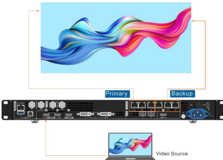
Figura 5-27 Connessione di backup della porta Ethernet
